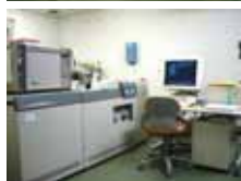
磁場型質量分析装置 (MStation) JEOL 製 JMS-700 二重収束型質量分析計 測定モード: 電子衝撃イオン化法 (EI) 高速原子衝撃法 (FAB)
